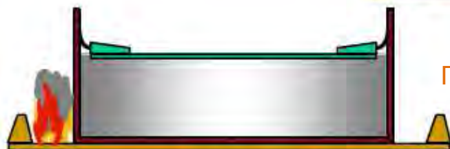
Bund Fire Пожар на обваловке
